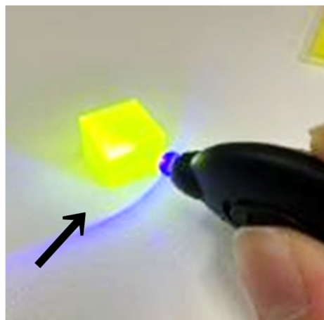
図3 シンチレータとして使用したGAGG ( \text{Gd}_3 (\text{Ga, Al})_5 \text{O}_{12}(\text{Ce}) )
