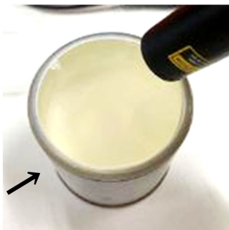
図4 シンチレータとして使用したNaI (ヨウ化ナトリウム)
