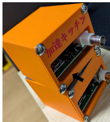
図2 2台の CosmicWatch の間に鉛板を挟んだ様子
