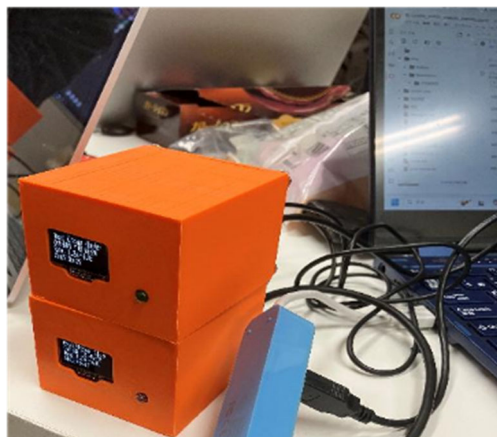
図1 宇宙線検出器 Cosmic Watch の原理と測定の様子
