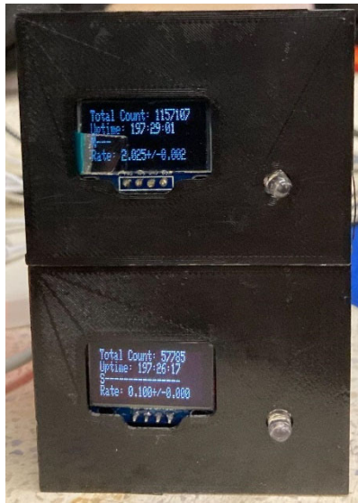
図3 CosmicWatch の coincidence 法での観測の様子
