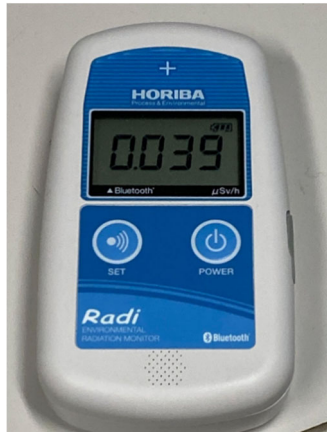
図 1. 環境放射線測定器 (HORIBA Radi PA-1100)
