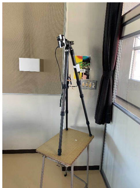
図17 Raspberry Pi、カメラ、バッテリーを固定した三脚
